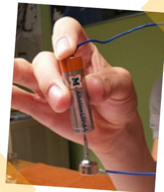
Bild 9: Einfacher Elektromotor
